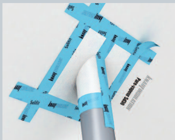
7 Raccordement sur tuyau à l'aide de la manchette universelle et de l'adhésif Solifit
